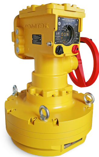
Рис. 2. Электропривод «РэмТЭК» неполнооборотного исполнения с планетарно-цевочным редуктором и выходным моментом 8500 Нм
